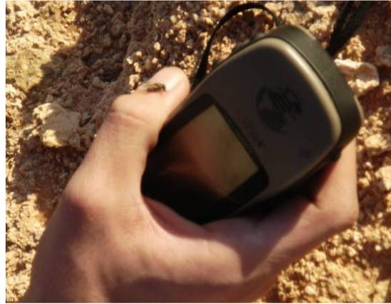
**fig. 8 Rilievo dei dati con il GPS**
