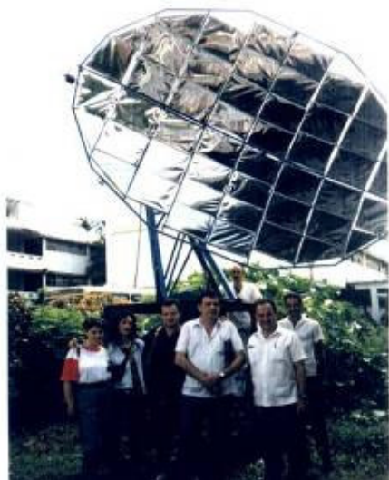
Prototipo di cucina solare a vapore da 3 kWp
